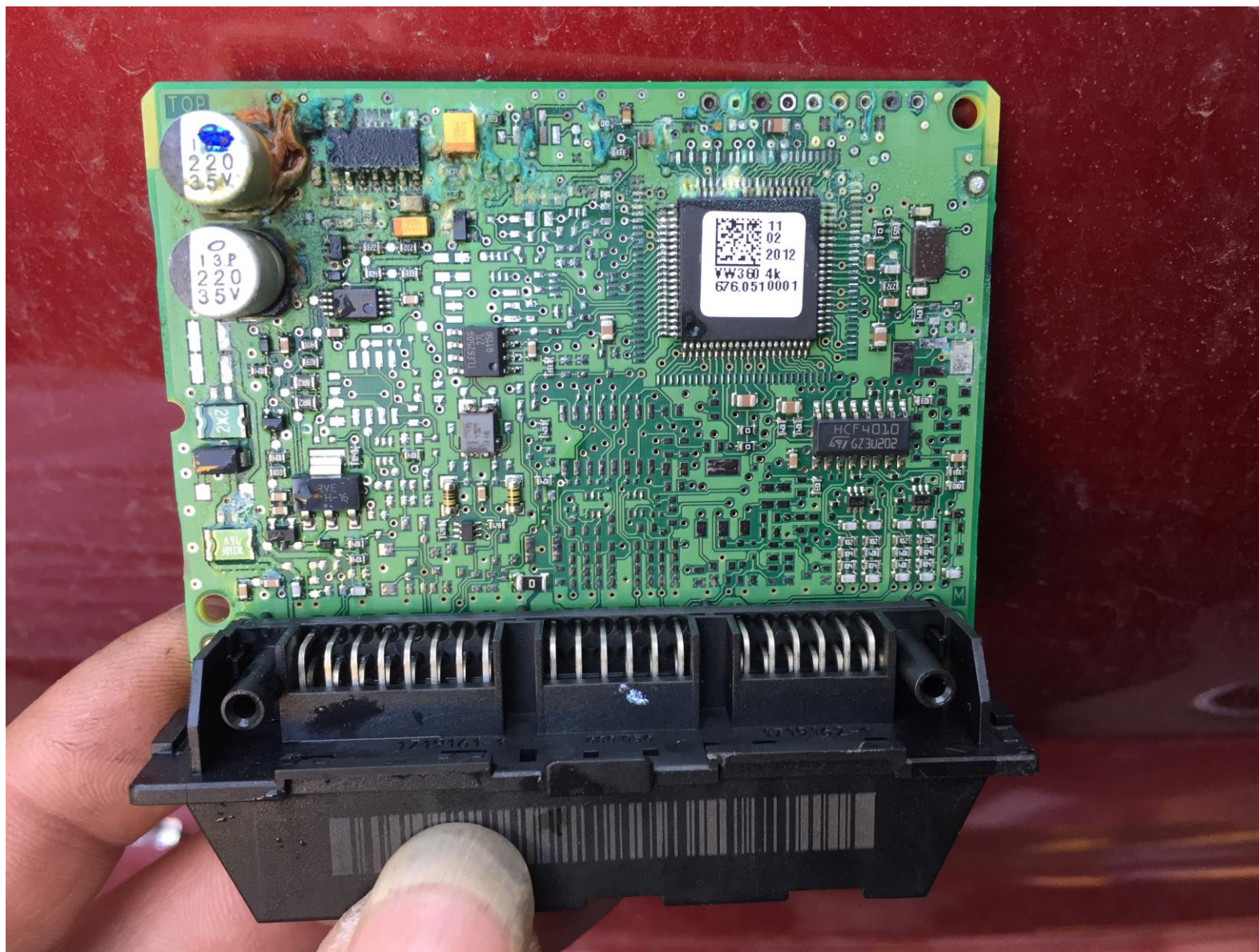
2.车辆熄火，拆取模块，查看外观样式和芯片
