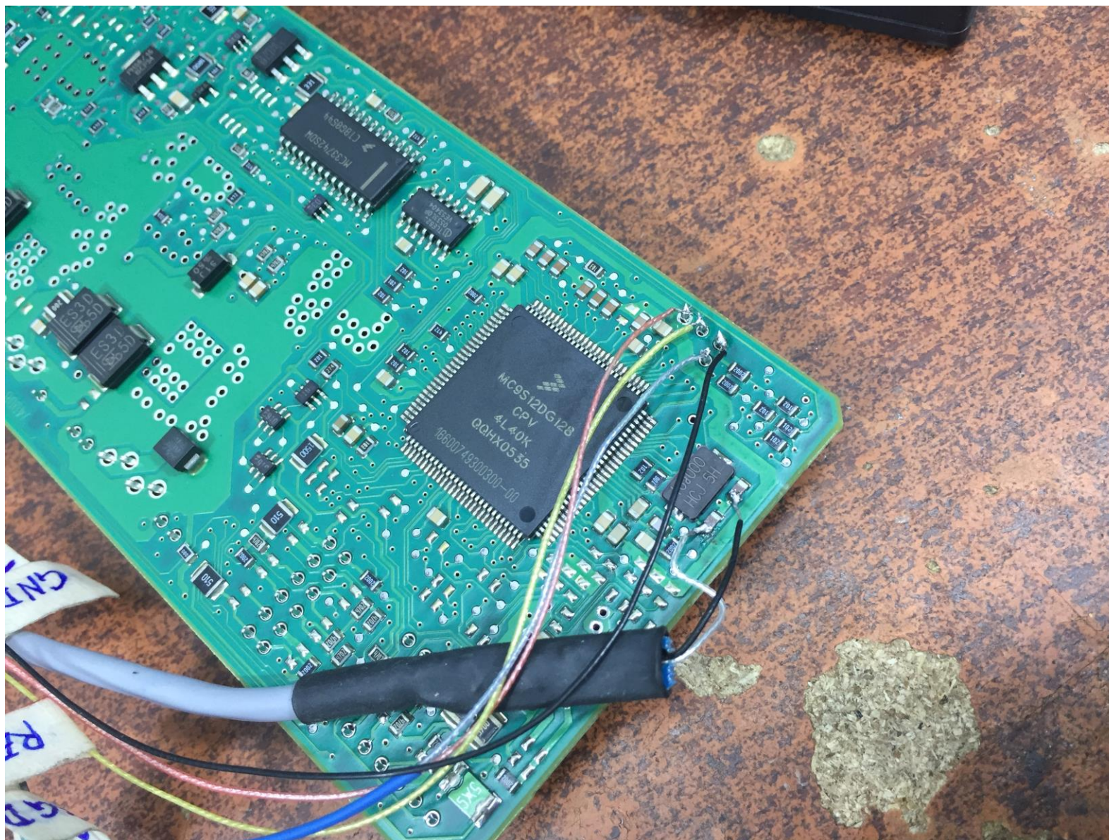
3.打开软件，根据接线图接线，进行数据读取
